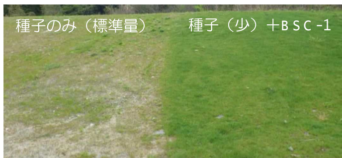
種子吹付に応用した例（種子量は左の種子吹付作業後の残り程度だが、植生が繁茂し、侵食も防止）
